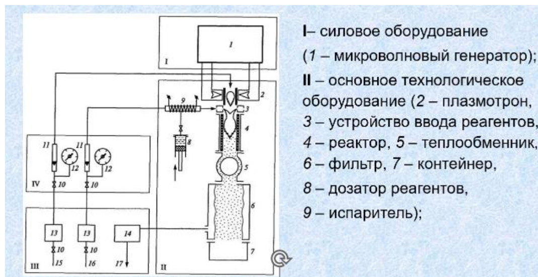
Рис. 3. - Схема СВЧ-установки плазмохимического синтеза
